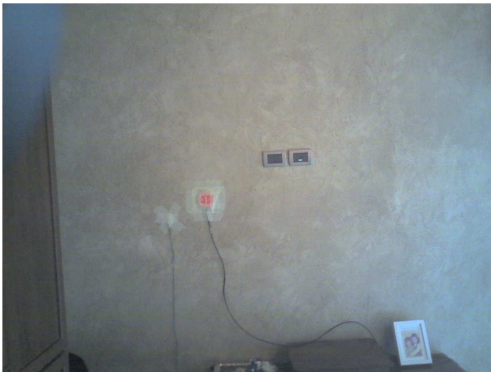
Immagine 3: L'immagine mostra la posizione della sonda termoflussimetrica e di temperatura superficiale interna.
