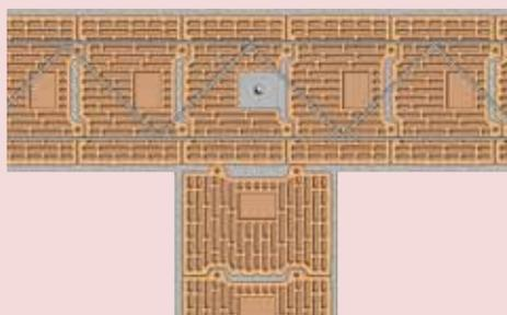
Analogamente al primo corso, l'intersezione si forma eliminando la cartella con presegno del blocco centrale, nei blocchi ad incastro spessore 30 e 35 cm, mentre per il blocco spessore 25 si lascia il blocco intero, andando a creare il pilastro nel foro centrale.
