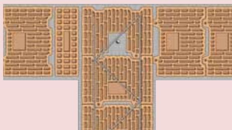
Analogo al secondo corso, con la differenza che nella soluzione ad incastro va spostata la posizione nel mezzo blocco Porotherm MOD 30-12/19 o, in alternativa, un mezzo blocco tagliato in cantiere.
