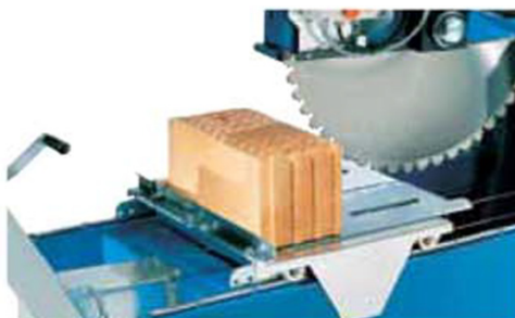
Taglio con idonea sega ad acqua. In alternativa sega a banco o motosega con lama per laterizio
