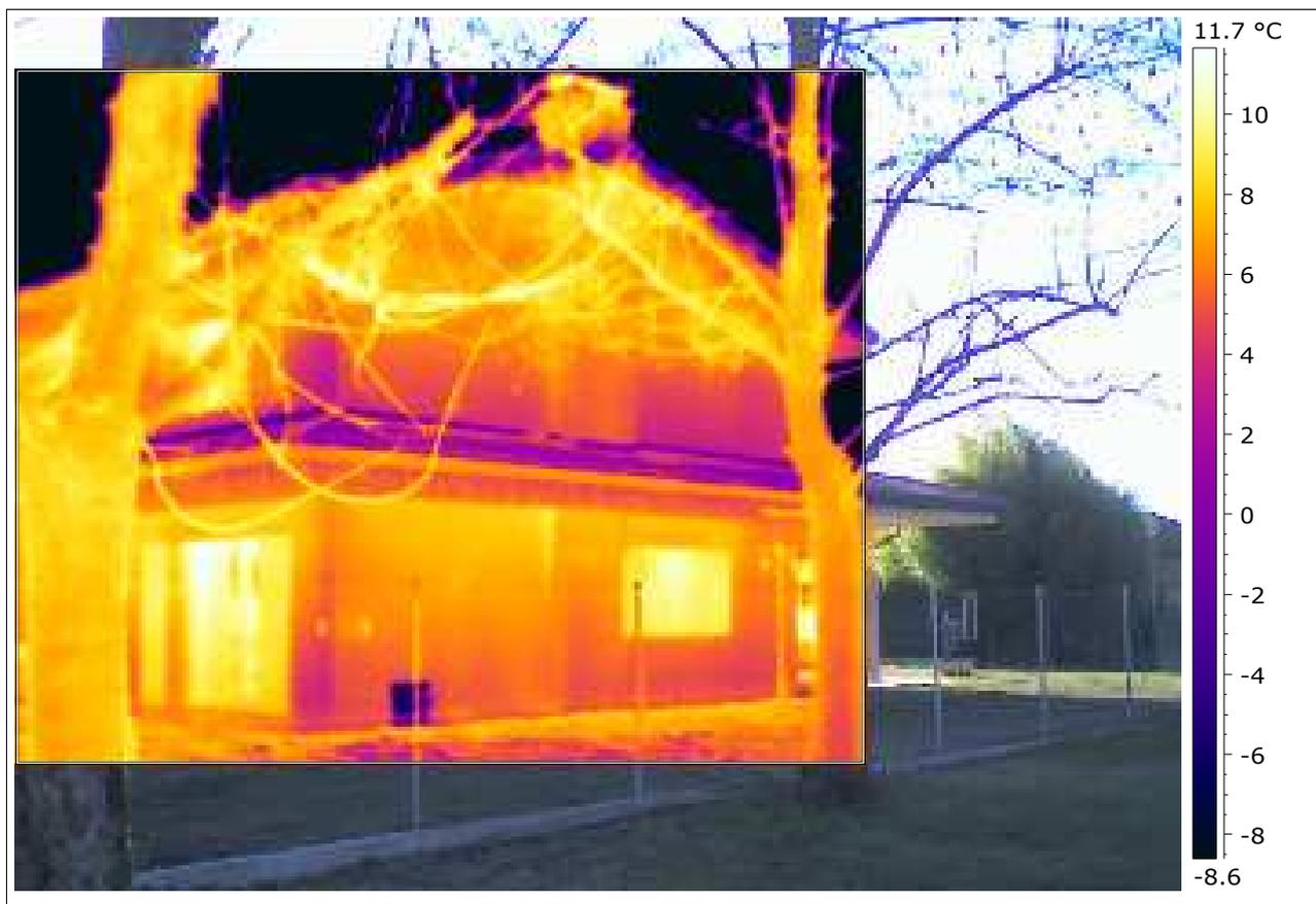
*Immagine 1: Veduta complessiva della superficie esterna della parete. La componente infrarossa dell'immagine mette in evidenza l'eccellente omogeneità della parete. In basso si nota il dispositivo di taratura della temperatura riflessa dell'ambiente esterno (riflette la temperatura del cielo).*
